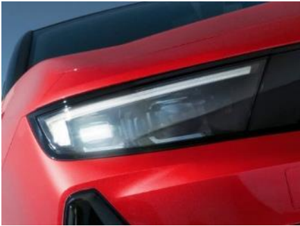
Intelli-Lux LED® pixelové svetlo Adaptívne svetlá s 84 LED prvkami v každom svetle sa prispôbujú dopravným podmienkam automatickým vypínaním jednotlivých jednotiek
